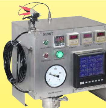
Испытательное оборудование для многократного и постоянного измерения максимальной длины соединительных трубок воздушного выключателя в зависимости от объема кнопки и развиваемого ею давления (лаборатория Ultimheat)
